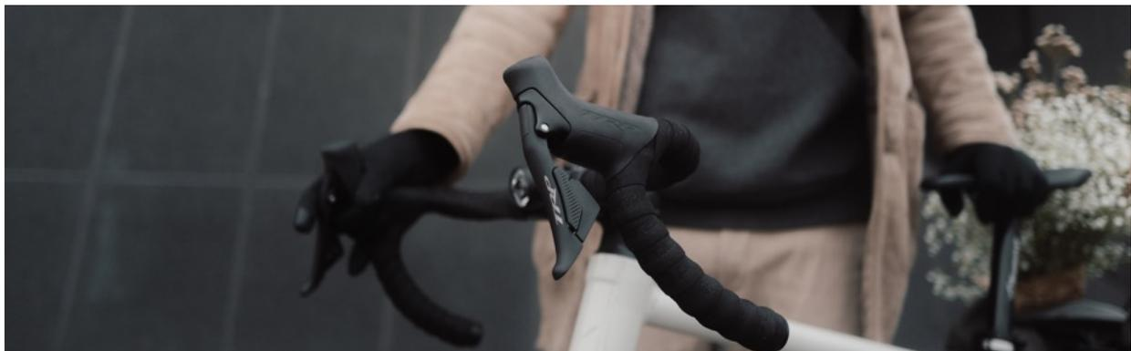
Bisher mussten Fahrer von E-Bikes mit einer 3X3 NINE Nabe auf die Nutzung von Drop-Bars verzichten. Die Kombination aus der zuverlässigen 3X3 NINE-Getriebenabe und dem TRP Hywave Schalthebel eröffnet im Zusammenspiel mit dem Bosch E-Shift-System nun eine völlig neue Welt aus präzisiertem Schalten und sportlichem Fahrverhalten.
